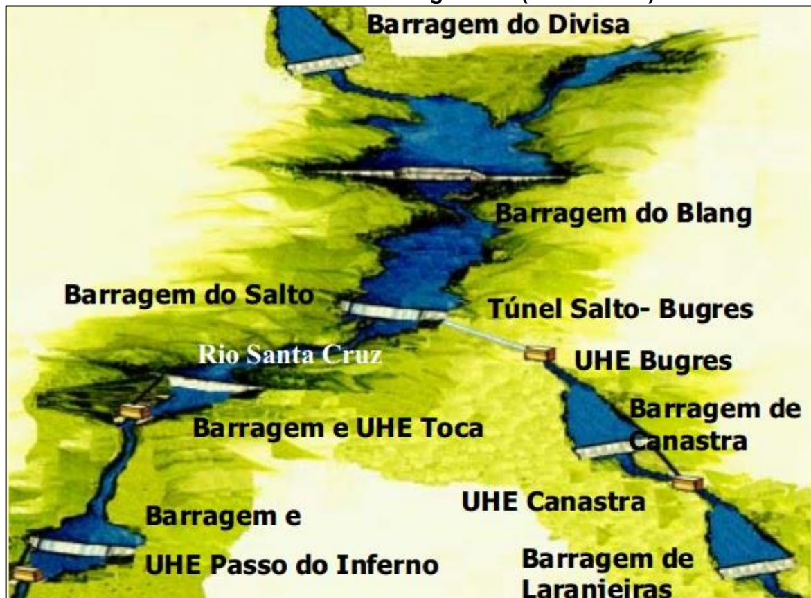
Figura 8 – Sistema Salto – Barragens, usinas e canal de transposição – Intercâmbio de bacias hidrográficas (Caí e Sinos)
