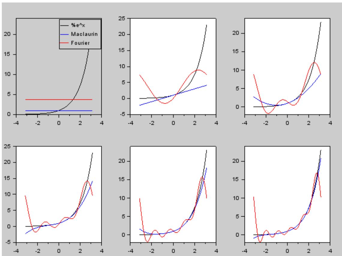
**Figura 1.** A curva em preto representa a função  $y = e^x$ , enquanto a curva vermelha a expansão em série de Fourier e a azul expansão em série de Maclaurin, cada janela gráfica representa as expansões com diferentes números no truncamento da série, respectivamente, 0, 1, 2, 3, 4, 5 e 6 termos.
