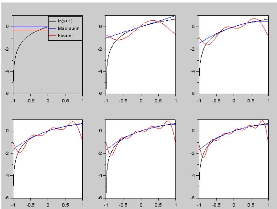
**Figura 4.** A curva em preto representa a função  $y = \ln(x + 1)$ , enquanto a curva vermelha a expansão em série de Fourier e a azul expansão em série de Maclaurin, cada janela gráfica representa as expansões com diferentes números no truncamento da série, respectivamente, 0, 1, 2, 3, 4, 5 e 6 termos.
