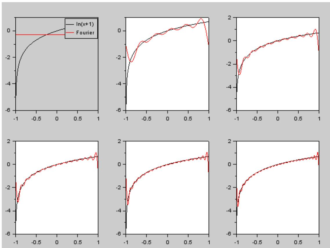
**Figura 6.** A curva preta representa a função  $y = \ln(x + 1)$ , enquanto a vermelha, a expansão em série de Fourier da mesma função para diferentes termos no truncamento da série, respectivamente, 0, 5, 10, 15, 20 e 25 termos.
