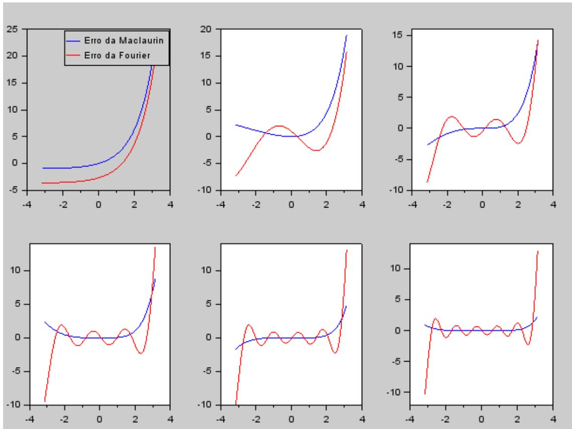
**Figura 2.** Os gráficos apresentam a diferença entre a função  $y = e^x$  com as expansões em séries da função, a curva azul representa o erro relativo da série de Maclaurin em diferentes termos no truncamento da série e a curva vermelha representa o erro relativo da série de Fourier em diferentes termos no truncamento da série. Ambos truncamentos são em respectivamente, 0, 1, 2, 3, 4, 5 e 6 termos no truncamento das séries.
