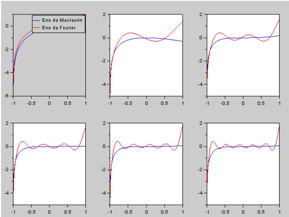
**Figura 5.** Os gráficos apresentam a diferença entre a função  $y = \ln(x + 1)$  com as expansões em séries da função, a curva azul representa o erro relativo da série de Maclaurin em diferentes termos no truncamento da série e a curva vermelha representa o erro relativo da série de Fourier em diferentes termos no truncamento da série. Ambos truncamentos são em respectivamente, 0, 1, 2, 3, 4, 5 e 6 termos no truncamento das séries.
