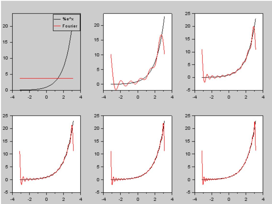
**Figura 3.** A curva preta representa a função  $y = e^x$ , enquanto a vermelha, a expansão em série de Fourier da mesma função para diferentes termos no truncamento da série, respectivamente, 0, 5, 10, 15, 20 e 25 termos.
