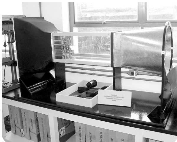
Túnel de vento criado no semestre passado serve para estudar princípios básicos de aerodinâmica
